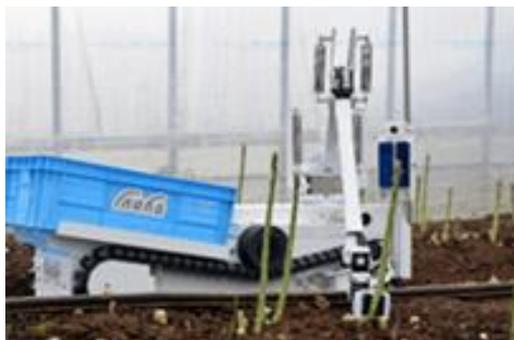
アスパラガス自動収穫ロボット（実証中）
