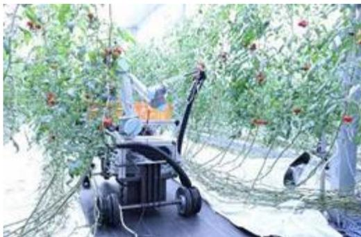
ミニトマト自動収穫ロボット（開発中）
